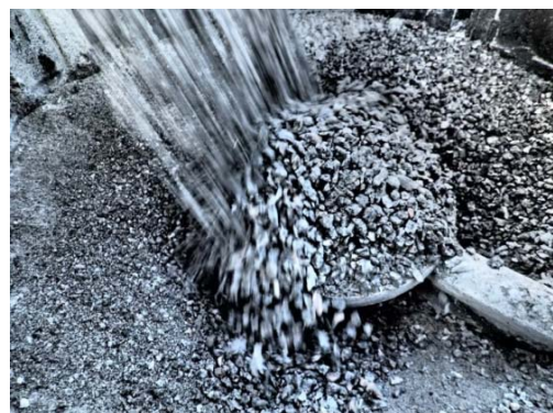
Figur 7. Materialflöde in i VSI-krossen
